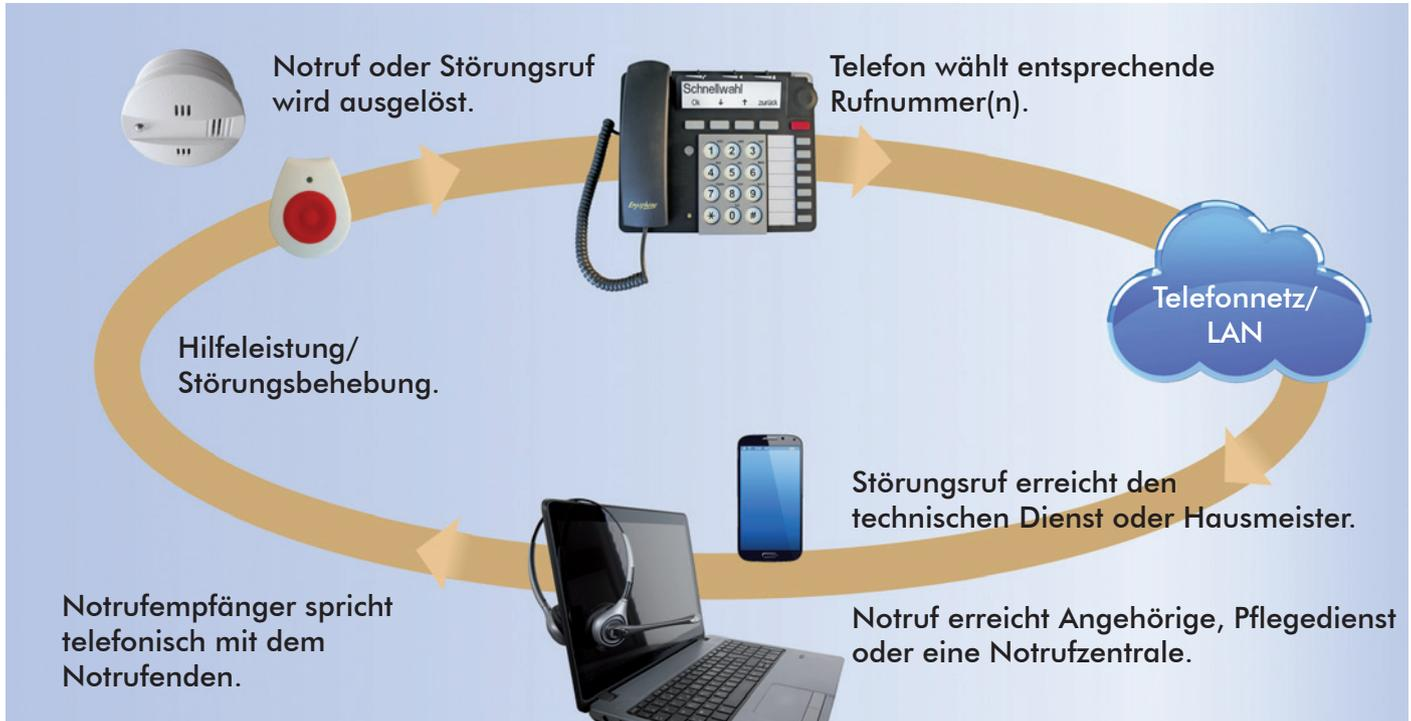
Abbildung: Ergophone Rufauslöser und Telefon in Verbindung mit Systemkomponenten anderer Hersteller.
