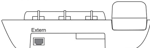
Über die Buchse „Extern“ werden drahtgebundene Zugtaster angeschlossen.
