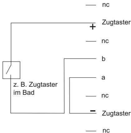
Der Anschluss a/b muss genügend Schleifenstrom liefern. Achten Sie auf die Polarität von a/b. Die Ader „a“ muss „minus“ sein. Anschlusslänge ca. 10...20 Meter innerhalb der Wohnung. Bei Gefahr von Brummeinstreuungen ist der Anschluss mit Stromversorgung zu bevorzugen, da keine galvanische Verkopplung mit dem Telefonnetz stattfindet.
