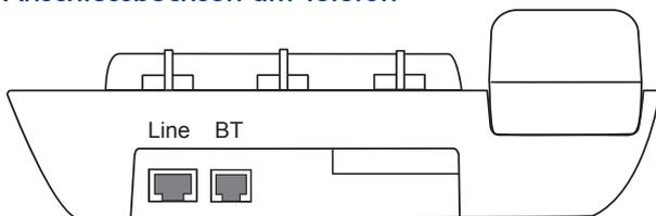
Buchse „Line“: Anschluss von a/b und Zugtastern (Kontakteingang). Buchse „BT“: Anschluss eines Birntasters.
